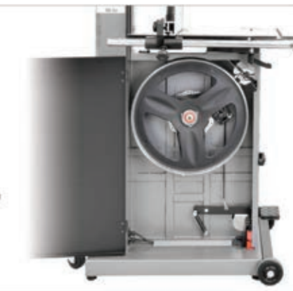
Kotoučová brzda pro rychlé zastavení pásu
